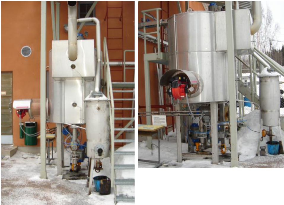
Kuva 2 Vasemmalla hidas pyrolyysilaitteisto ja oikealla puukaasua tuottava myötävirtakaasutin.
