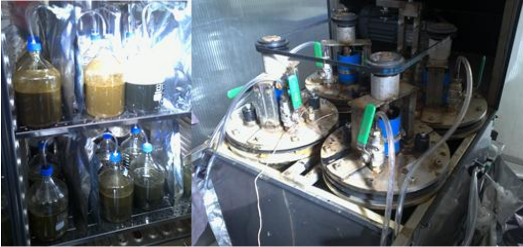
Kuva 4 Biokaasupanoskokeet ja jatkuvatoimiset biokaasureaktorit.
