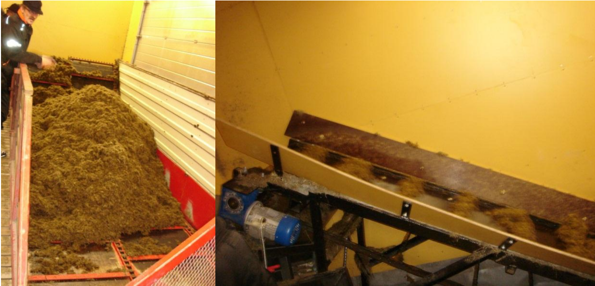
Kuva 3. Heinän syöttölava josta silputtu heinä kulkee pohjapurkaimen avulla hammashihnelle ja siitä ruuville. Syöttö 1 paali päivässä.
