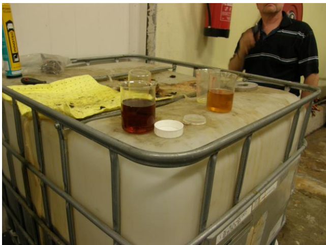
Kuva 2: Vasemmalla valmista biodieseliä, oikealla raakaa rasvasta tuotettua öljyä.
